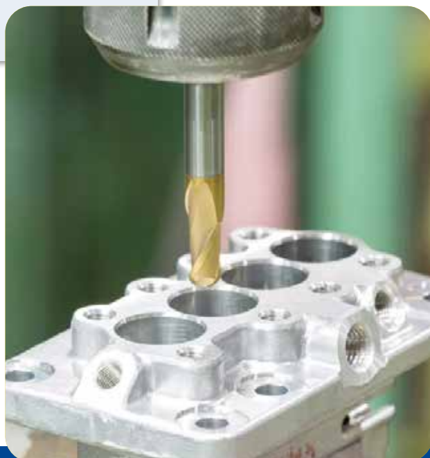
Perçage de centrage sur alliages légers au silicium, série 4000 (aluminums de fonderie).
