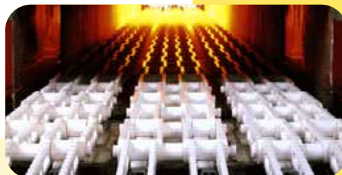
Lubrification d'entraînements de tapis de fours. Cuisson de polymères conducteurs phénoliques/argent à 220 °C en continu.
