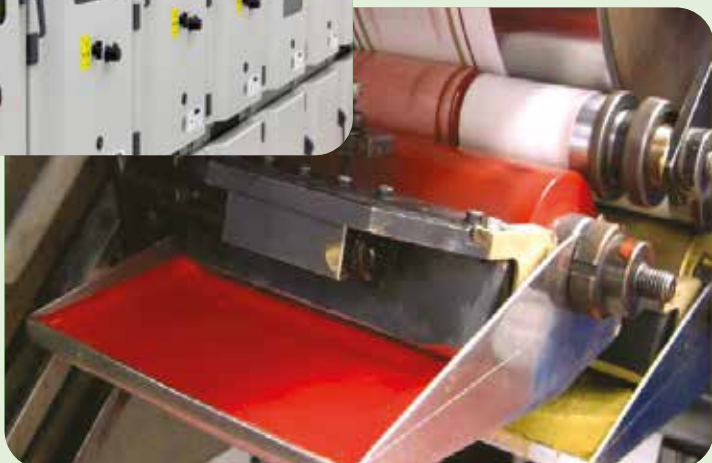
Nettoyage des encres en flexographie.
